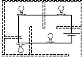
Un electricista le dice al arquitecto que debe cambiar el circuito porque al fallar uno de los bombillos se apagarán los demás. Él explica que en un circuito en serie, la corriente es la misma en todas las partes del circuito, mientras que en un circuito en paralelo, la diferencia de potencial es la misma en todas las partes del circuito. De acuerdo con lo que explica el electricista, ¿cuál es el mejor diseño que debería elaborarse para que la casa siempre esté iluminada si se daña un bombillo?
